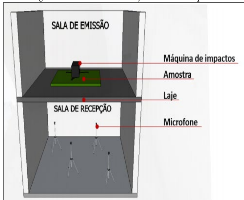
Figura 22 - Cadeia de medição ruído de impacto.
