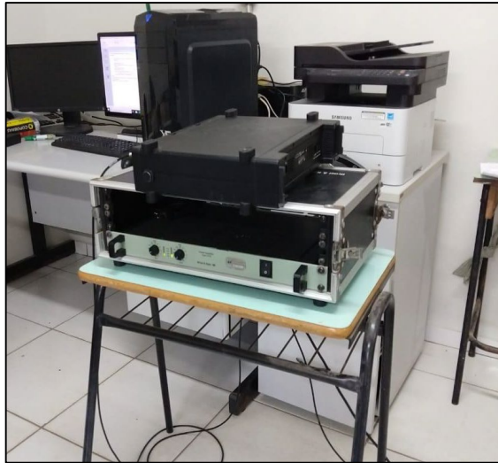
Figura 19 - Medidor de pressão sonora e amplificador de sinal.
