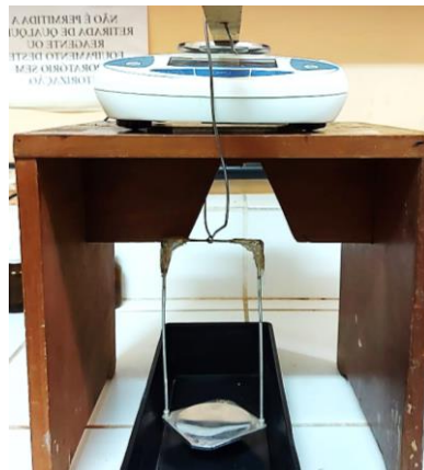
Figura 19 - Aparato para obtenção da massa imersa
