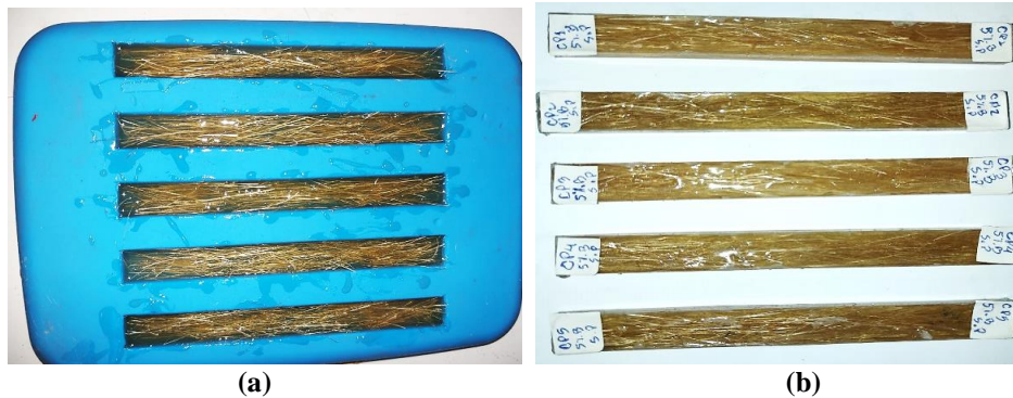
Figura 13 - Molde de silicone com a mistura (a) e corpos de prova com fibras de bambu (b)
