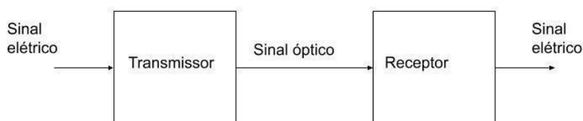
Figura 12 - Funcionamento de um conversor de mídia
