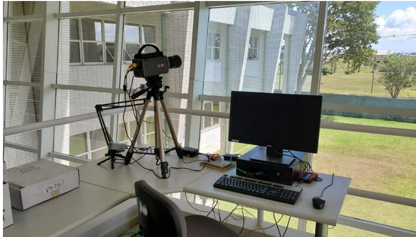
Figura 3.6 – Sistema de captura de descargas atmosféricas.
