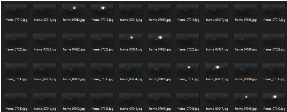
Figura 4.5 – Frames para um registro de trigger referente à 4 strokes (Os pares de frames com pontos claros são aqueles em que o LED está aceso. Entre esses pares há uma sequência de 10 frames com o LED apagado).
