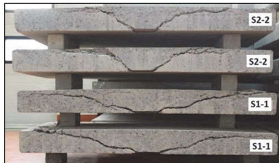
Figura 5– Ruptura por punção: modelos com e sem armadura de cisalhamento.
