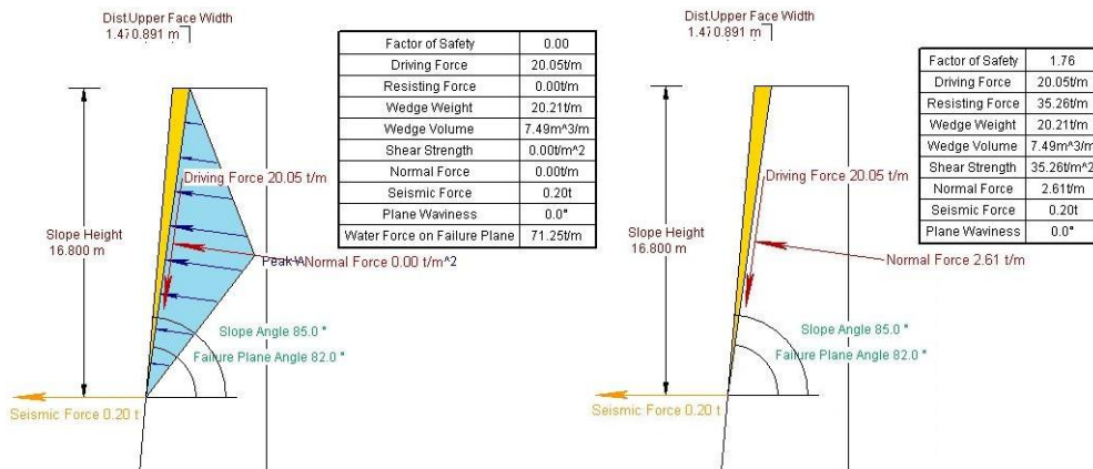
6 x T1 - Análise de Escorregamento Planar do Plano A - Desenho a esquerda: Plano com presença de água; Desenho a direita: Plano sem presença de água
