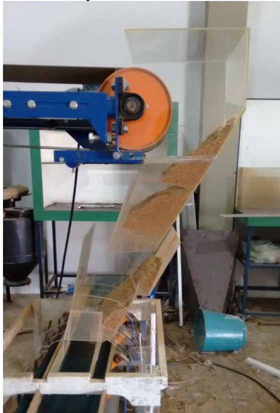
Figura 13. Bancada de transportadores de correia em chute de transferência.
