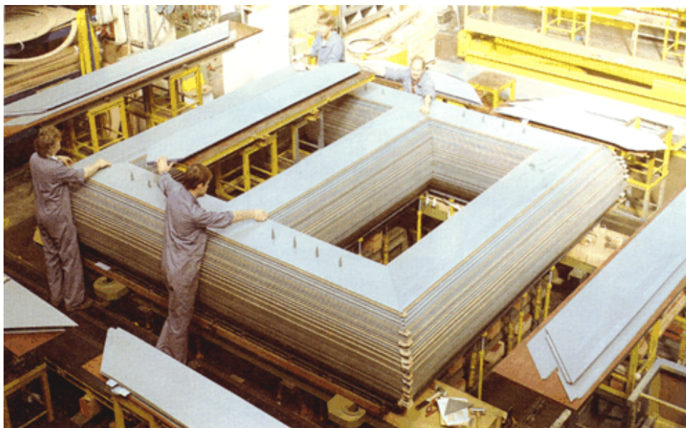
Figura 2.17 – Núcleo Laminado de um Transformador de potência
