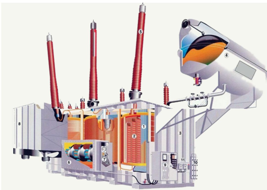
Figura 2.16 – Transformador de Potência
