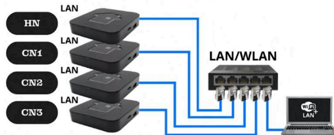
Figura 3. Topologia de rede do cluster de tv box. Fonte: Autores (2024)
