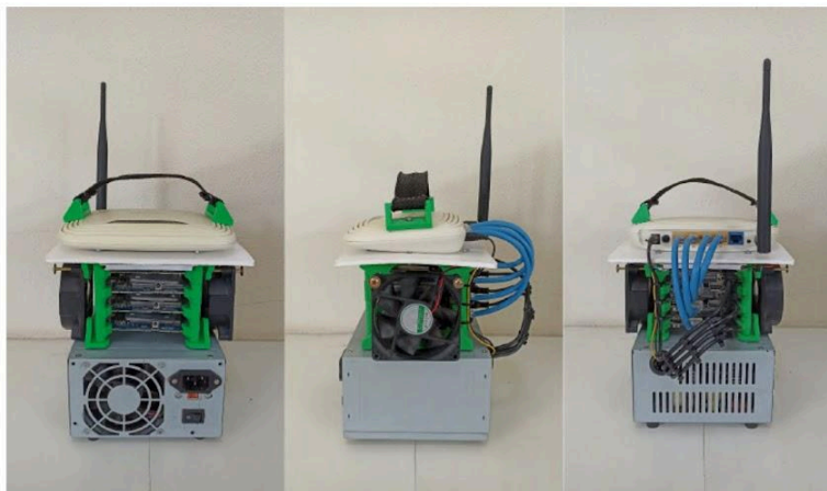
Figura 2. Montagem final do cluster. Fonte: Autores (2024)
