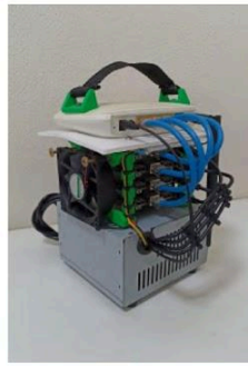
Figura 4. Organização dos cabos ethernet do cluster. Fonte: Autores (2024)
