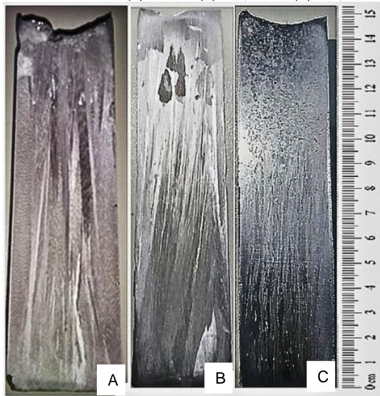
Figura 18 – Macroestrutura (A) Al-9%Ni (B) Al-2,5%Ni e (C) Al-4,5%Cu-2,5%Ni.
