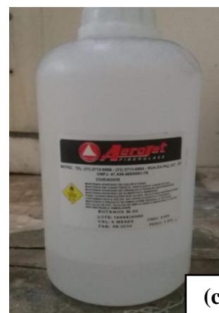
Figura 6: Materiais utilizados: (a) Resina polimérica; (b) Acelerador de cobalto; (c) Iniciador de Butanox; (d) Balança; (e) Fibra de juta; (f) Fibra de vidro.
