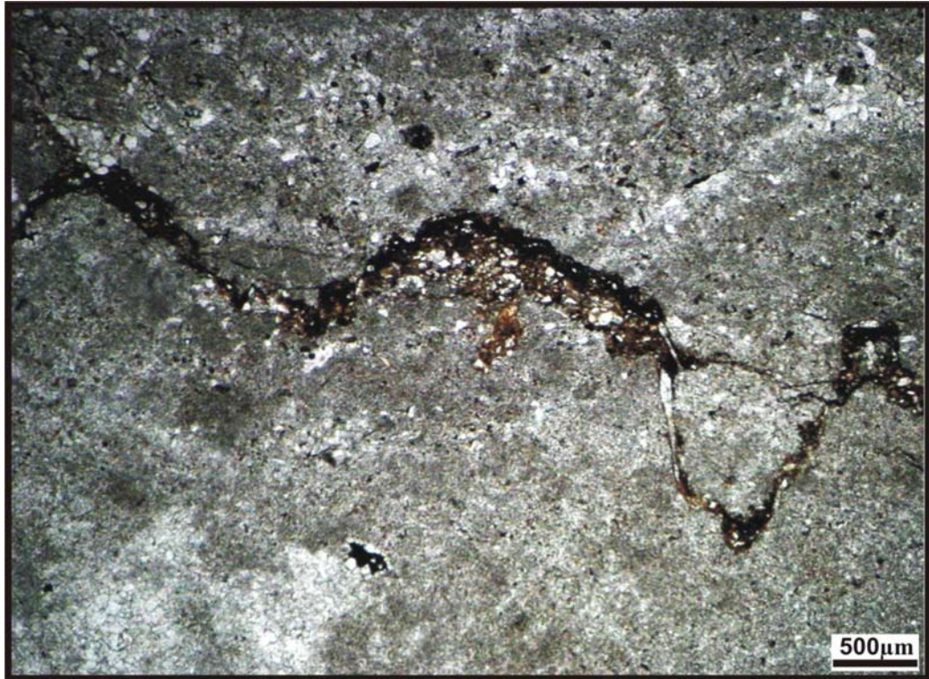
FIGURA 46 - Concentração de grãos terrígenos, oxi-hidróxidos de ferro, minerais autigênicos e matéria orgânica em estilólitos.
