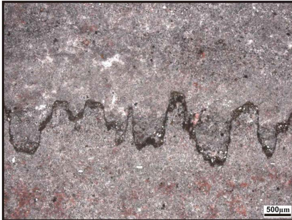
FIGURA 44 - Fotomicrografia de estilólitos, caracterizados em perfil por linhas suturadas, e, em planta, por superfícies irregulares
