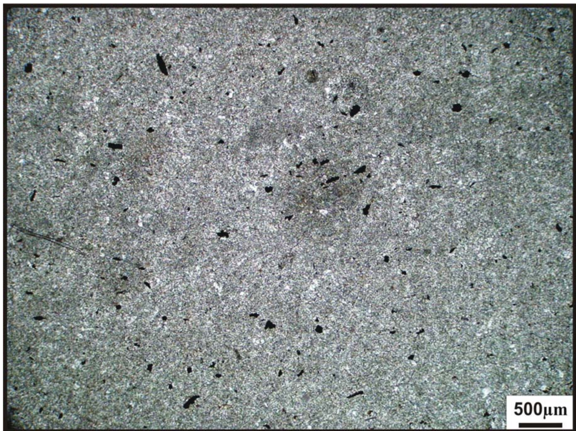
FIGURA 20 - "Calcita microespática" com aspecto sujo, resultante da impregnação por betume ou oxihidróxidos de ferro nos microporos intercristalinos. Os pontos pretos são disseminações de minerais autigênicos, como a pirita e a pirrotita (?). Fotomicrografia sob nicóis paralelos.
