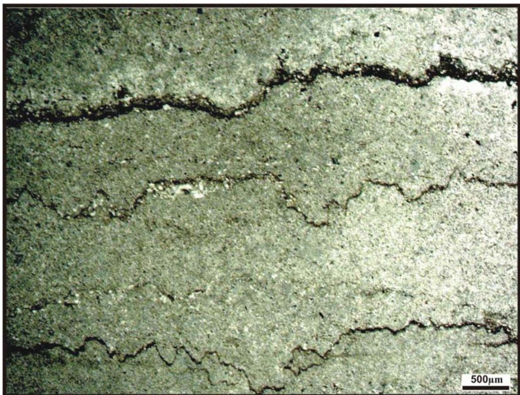
FIGURA 47 - Feição de pseudoacamamentos dado pela disposição paralela dos estilólitos.
