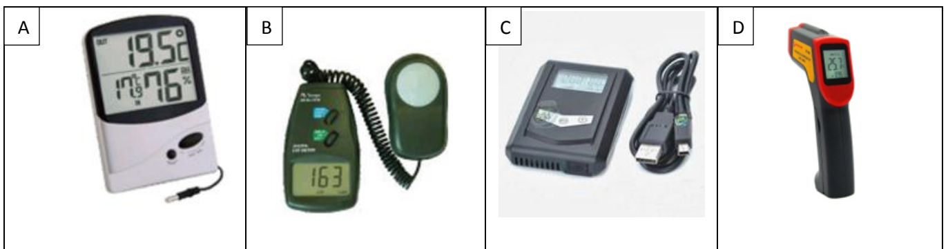
Figura 10: Exemplos de aparelhos de Monitoramento de Umidade, Temperatura e Luminosidade. A: Termohigrômetro; B. Luxímetro; C. Datalogger; D. Termometro de Infra Vermelho. Fonte: Medjet 15
