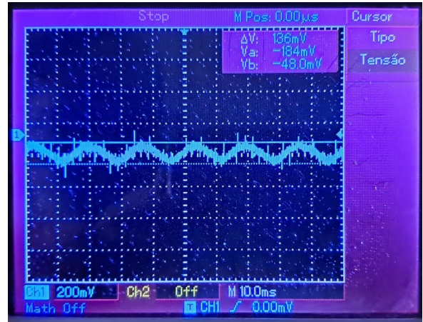
(b) Desempenho do MultipleFeedBack em Protoboard .
