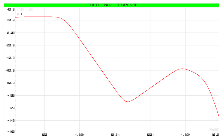
Figura 27 – Resposta em frequência simulada do filtro passa-baixas.
