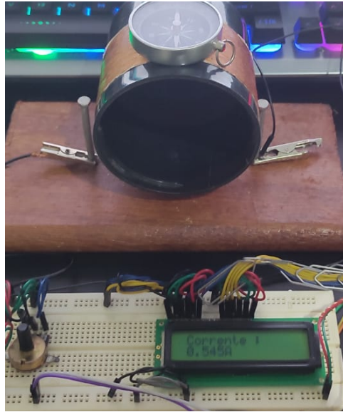
Figura 4.35 – Experimento de Oersted - Medindo a corrente
