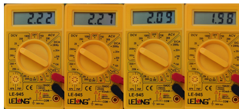
Figura 4.59 – Leitura de tensão no gerador eletromagnético
