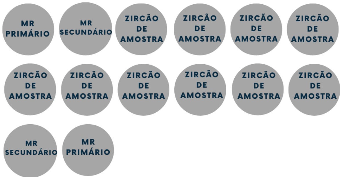
Figura 7 – Fluxo analítico adotado no Pará-Iso para as análises pontuais U-Pb em zircão por LA-Q-ICP-MS.
