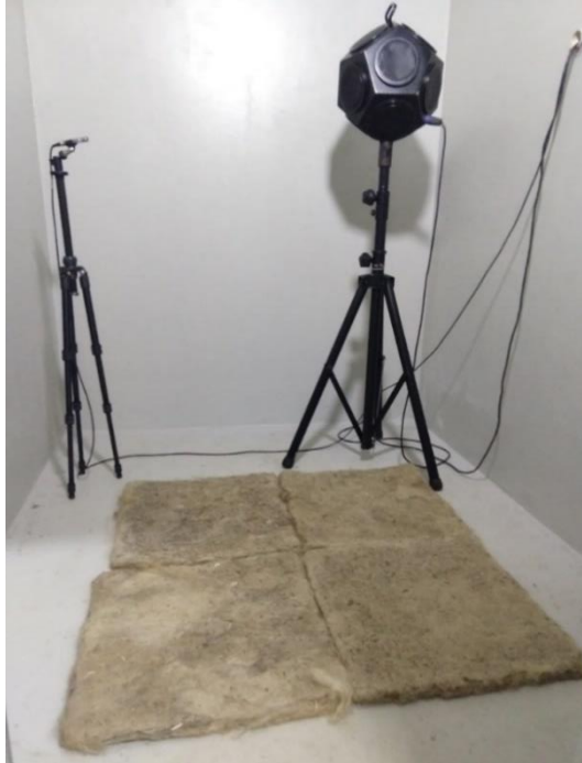
Figura 15. Painel plano de juta na câmara reverberante.
