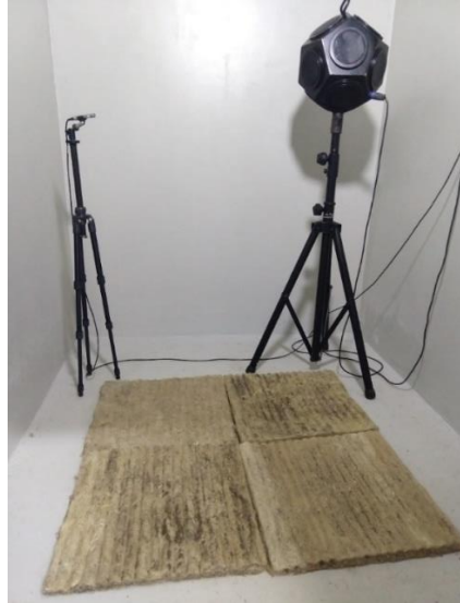
Figura 19. Painel de juta com superfície não plana na câmara reverberante.
