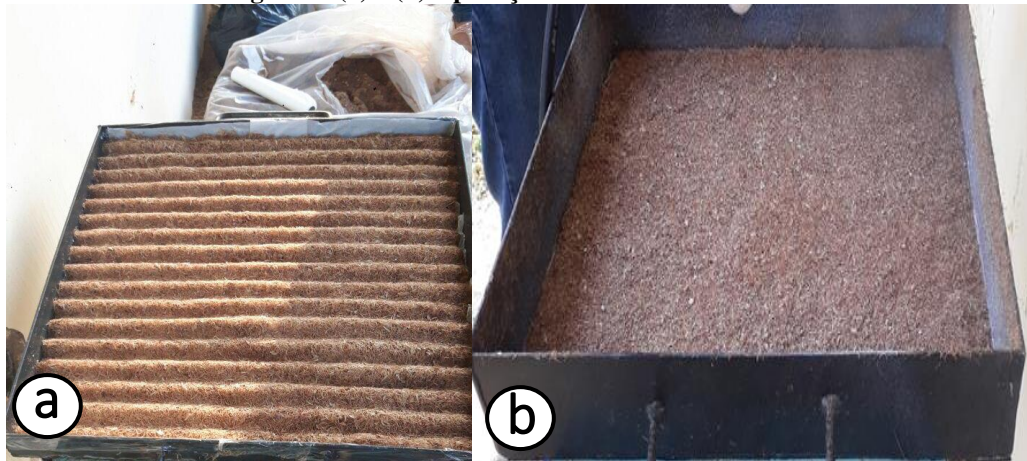
Figura 8. (a) e (b) Aplicação das camadas de fibras.
