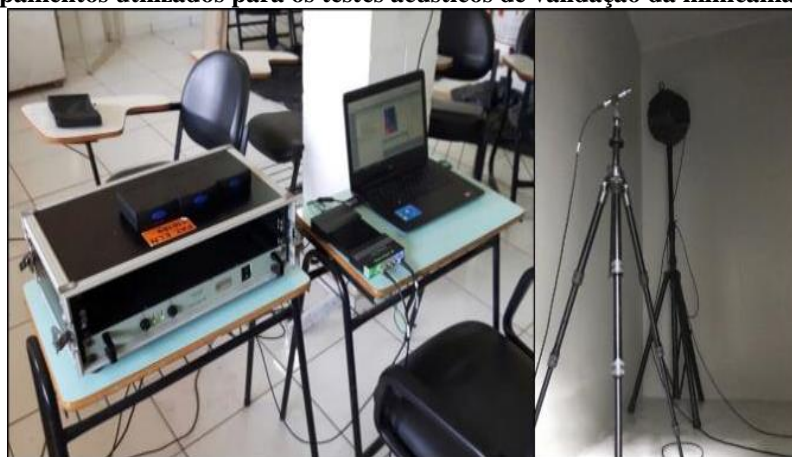
Figura 11. Equipamentos utilizados para os testes acústicos de validação da minicâmara do CAMTUC.
