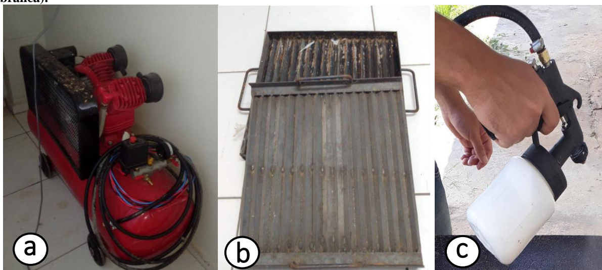
Figura 4. Materiais utilizados: (a) compressor, (b) molde e (c) pistola (utilizada na aplicação de cola branca).
