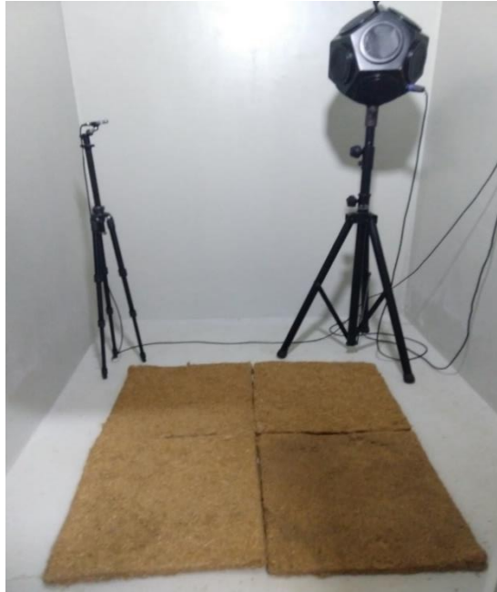
Figura 13. Painel plano de açai na câmara reverberante.
