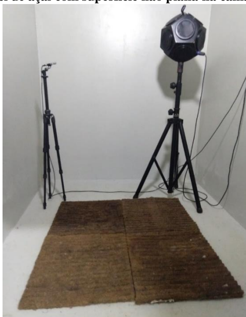
Figura 17. Painel de açai com superfície não plana na câmara reverberante.
