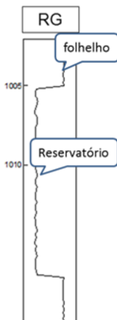
Figura 03 – Perfil de raio gama natural do poço sintético A.
