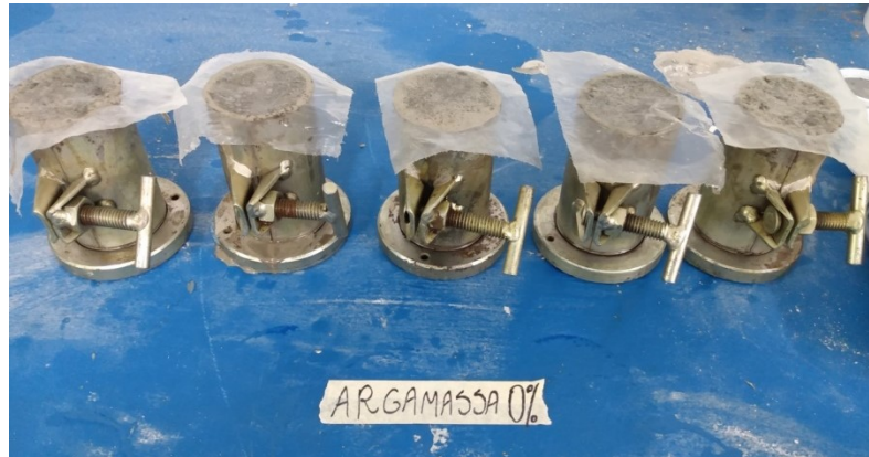
Figura 14 – Disposição dos moldes de argamassa com 0% de areia.
