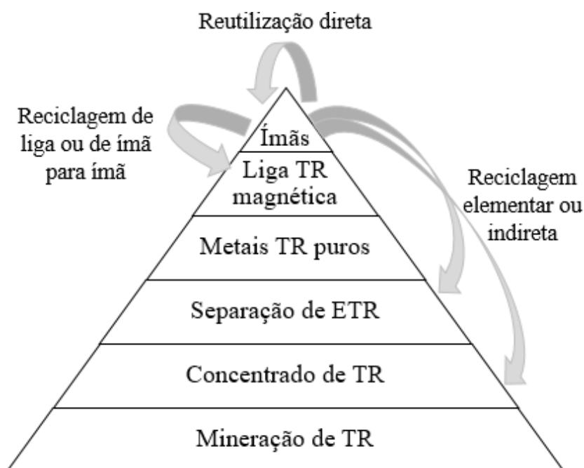
Figura 10 - Esquema de obtenção de ímãs a base de TR evidenciando as possíveis rotas de reciclagem. Fonte: Adaptado de (Diehl et al. 2018).
