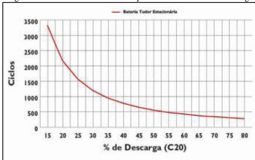
Figura 38 – Ciclos da bateria em função da Profundidade de Descarga.
