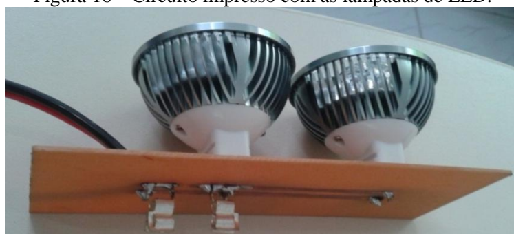
Figura 16 – Circuito impresso com as lâmpadas de LED.
