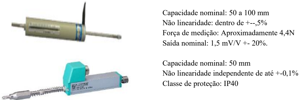
Figura 11 - Equipamentos utilizados para medição dos deslocamentos
