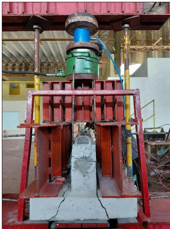
Figura 10 – Representação de um ensaio realizado em viga de concreto armado.
