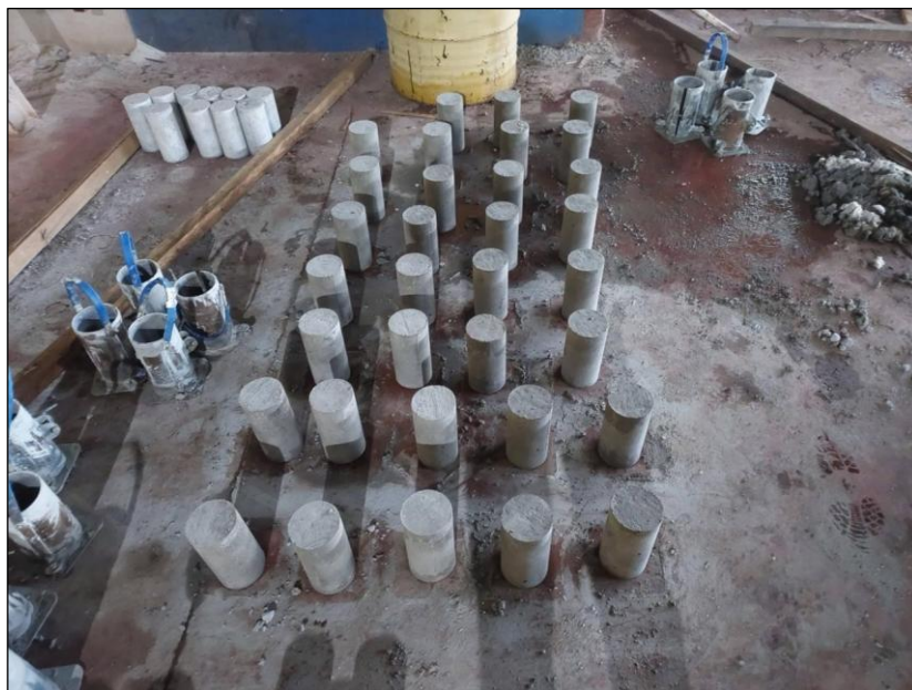
Figura 15 – Representação da moldagem dos corpos de prova cilíndricos
