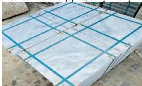
Figura 4: Exemplar cintados com tiras ou blocos de papelão, solda por fusão plástica e uso de palete reciclado
