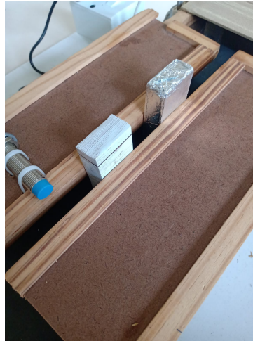
Figura 33 – Fixação de placas em MDF para direcionamento do material transportado.
