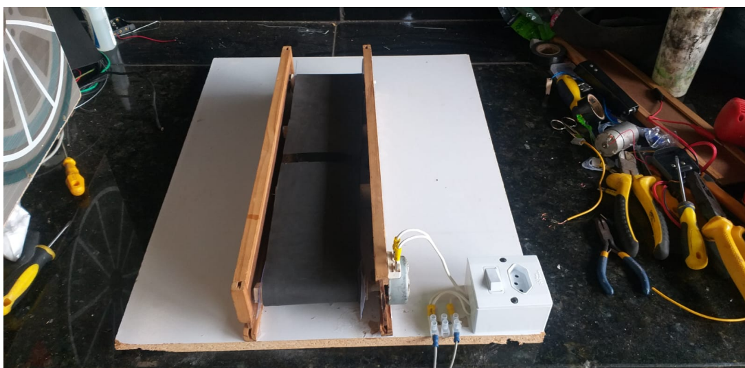
Figura 29 – Instalação da Tomada Para Alimentação da Placa Arduino e do Motor de Passo
