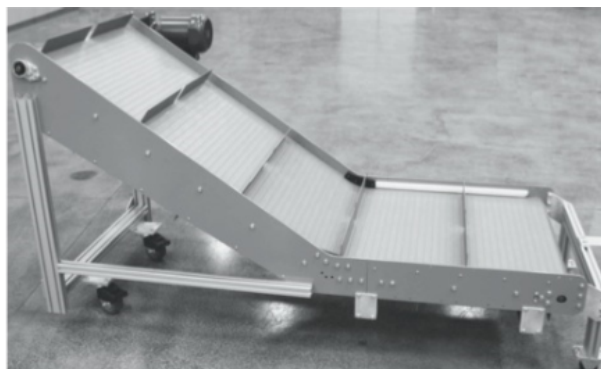
Figura 3 – Sistema transportador por correia com blocos inclinados
