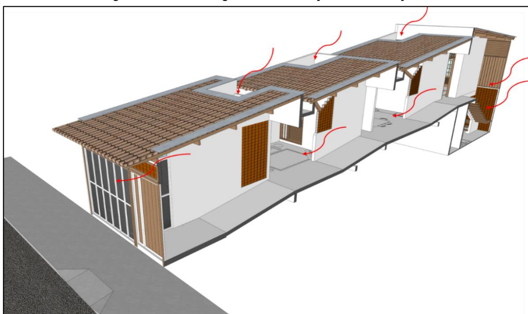
Figura 34: Corte longitudinal, indicação de ventilação.
