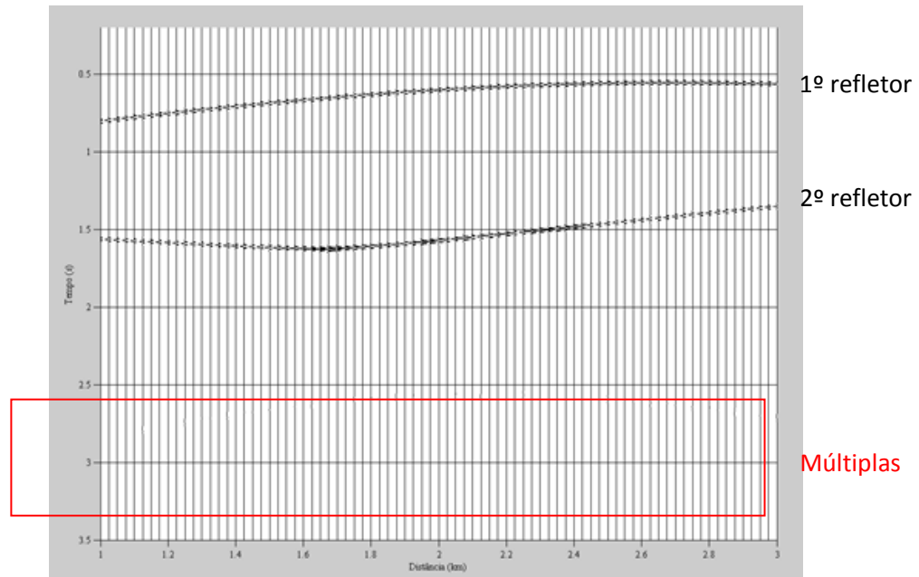
Figura 6.2. Seção afastamento-nulo (AN) obtida através do traçamento de raio com o software SEIS88. Reflexões múltiplas destacadas pelo retângulo vermelho.
