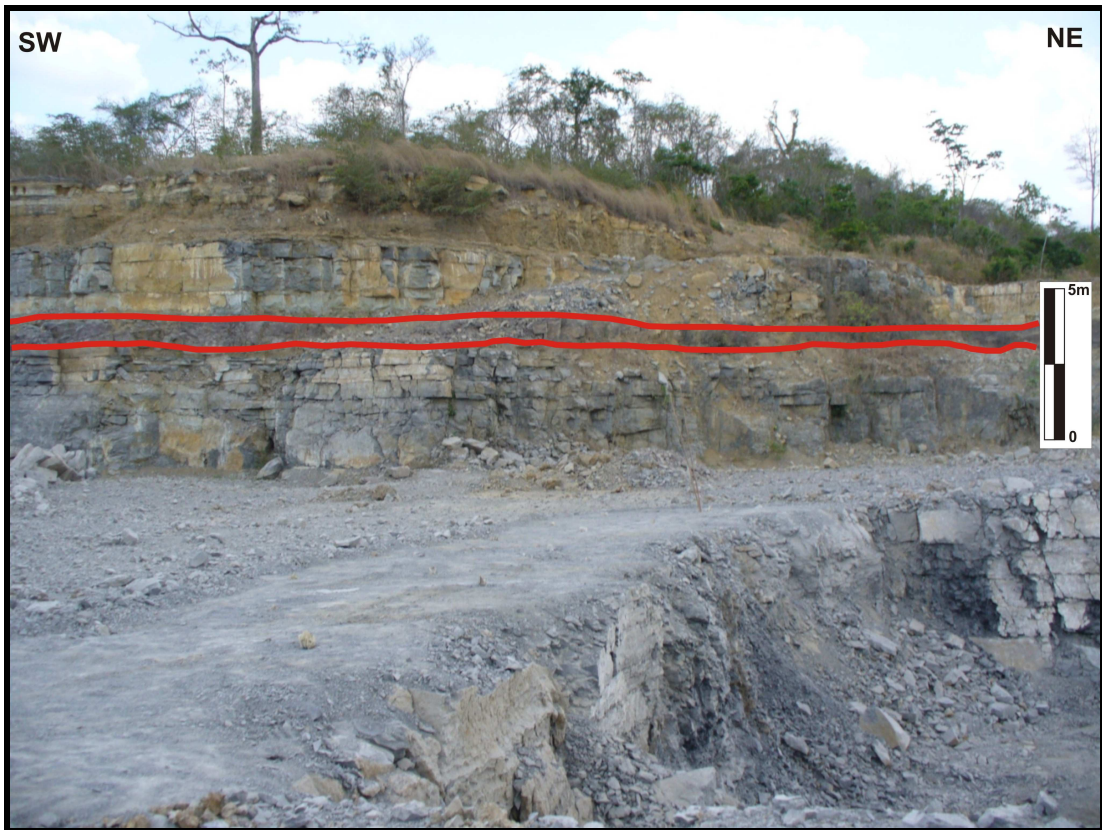
Figura 4. Mina Calpará, com calcários intercalados com folhelhos e dolomitos. Em destaque de vermelho, camada de arenito.
