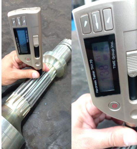
Figura 30. Análise de dureza do pinhão original.
