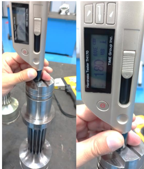
Figura 32. Análise da dureza do pinhão fabricado.
