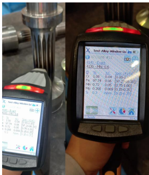
Figura 33. Análise da composição química do pinhão fabricado.
