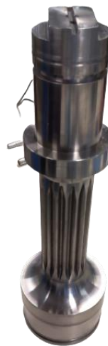
Figura 14. Pinhão atuador pneumático original.
