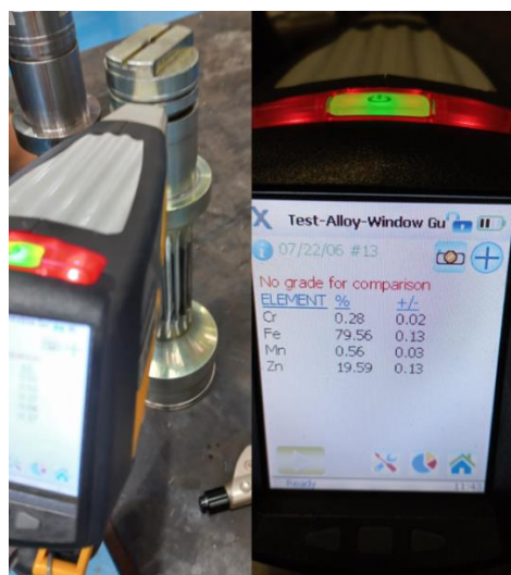
Figura 31. Análise de composição química no pinhão original.
