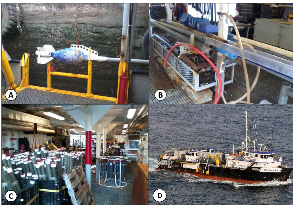
Figura 22 - Testemunhador a pistão utilizado para a amostragem do estudo (A e B); Testemunhos recuperados (C); Navio Geoexplorer (D). 1
