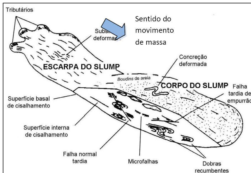
Figura 8 - Representação esquemática de um corpo de escorregamento ( slump ). Fonte: Modificado de Shanmugam (2016).
