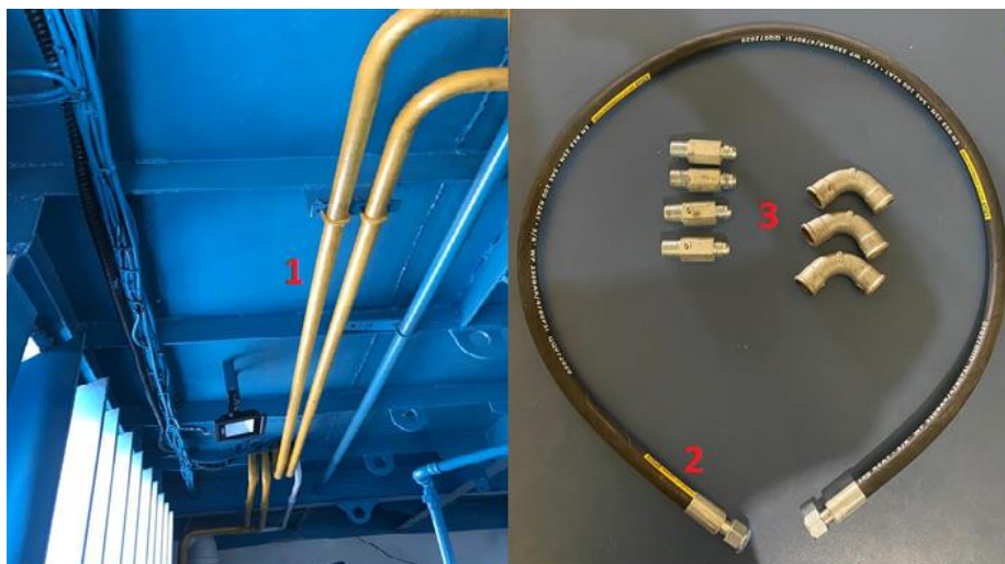
Figura 27. Condutores hidráulicos: 1-tubulação; 2-mangueiras; 3-conexões
