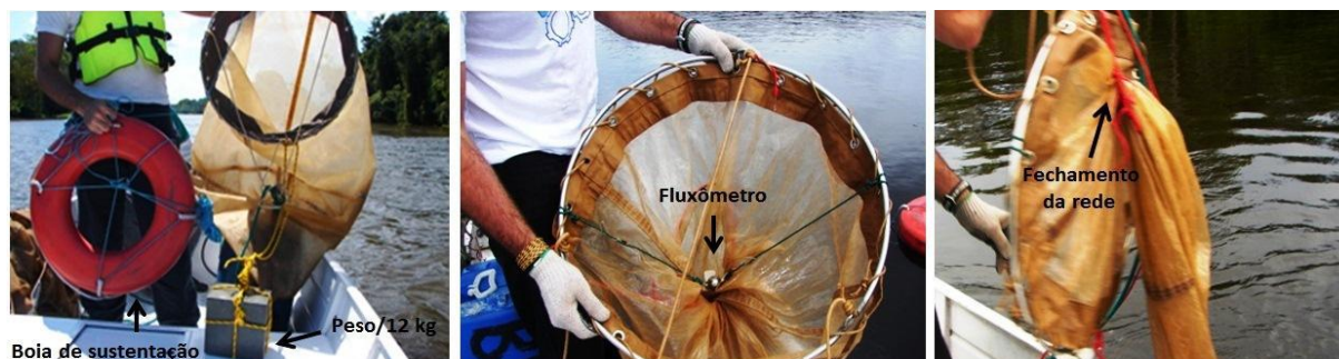
Figura 2: Detalhe da rede de plâncton cônico-cilíndrica adaptada para utilização em coletas de profundidade, nos ambientes de lagos e canais da RDSM, Amazônia Central, Brasil.
