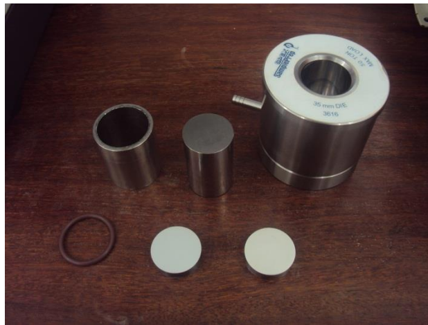
Figura 8 – Porta-amostra para preparação de pastilhas prensadas (LCM/IG/UFPA)
