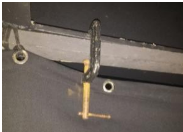
Figura 41: sargento utilizado na formação de coxias. Fonte: Registro do pesquisador
