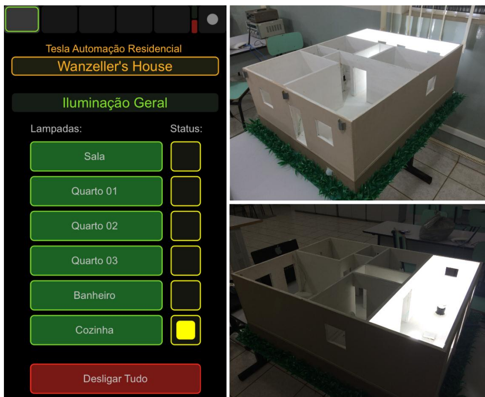
Figura 5.5 - Acionamento das lâmpadas da cozinha
