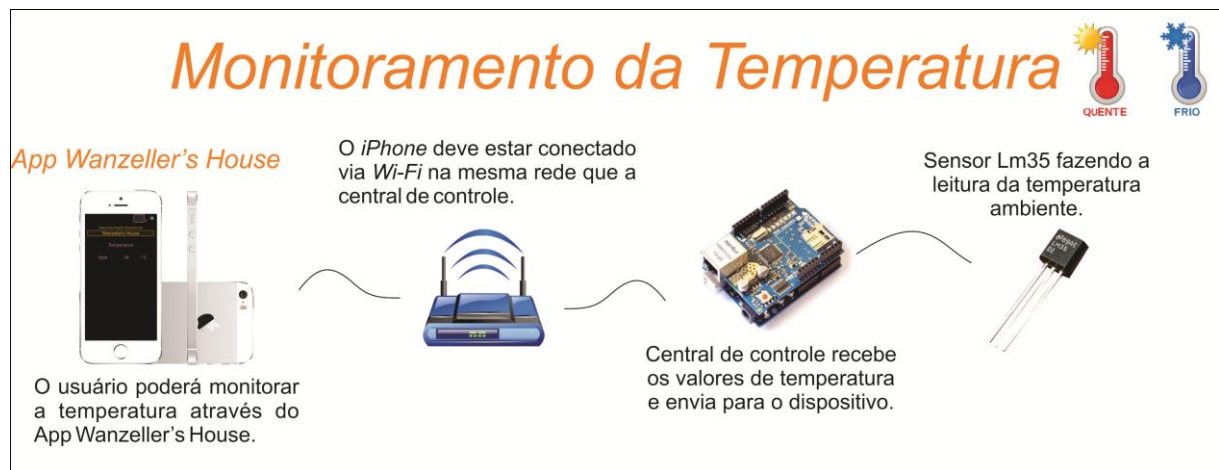
Figura 4.3 - Esquema geral do monitoramento da temperatura ambiente
