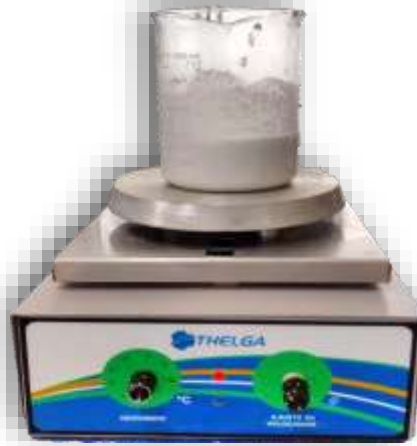
Figura 17 - Agitação magnética dos precursores
