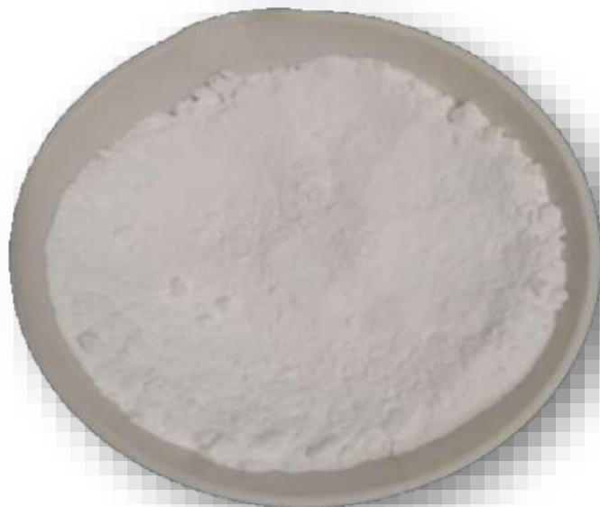
Figura 22 - Pó desaglomerado e peneirado
