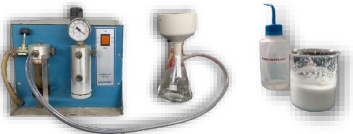
Figura 18 – Aparato utilizado para lavagem do material
