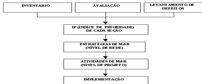
Figura 1 – Relação das estratégias de manutenção e reabilitação com as outras etapas de um sistema de gerência de pavimentos
