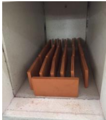
Figura 6 - Disposição dos corpos de prova para a sinterização.
