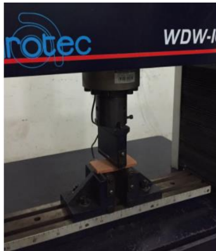
Figura 7 - Máquina universal utilizada para ensaios de resistência à flexão.
