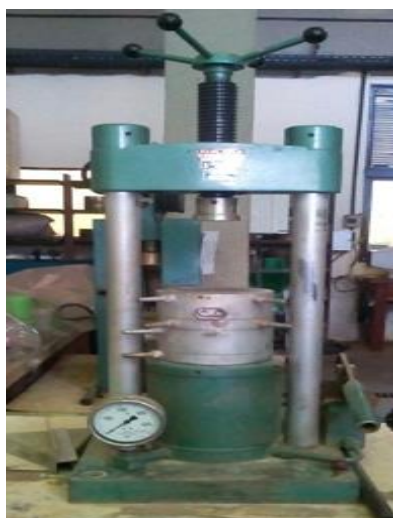
Figura 5 - Imagem da prensa utilizada para a moldagem dos corpos de prova.
