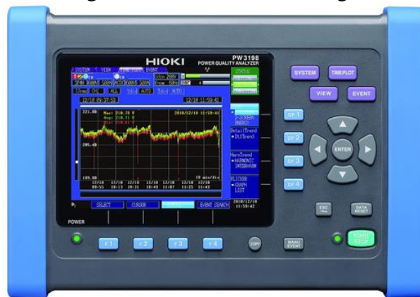
Figura 9 – Analisador de energia
