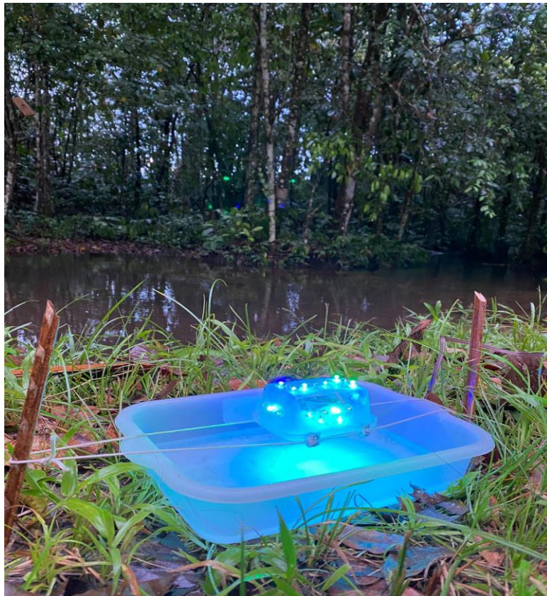
Figura 1: Armadilha luminosa com bandeja e luzes de LED.
