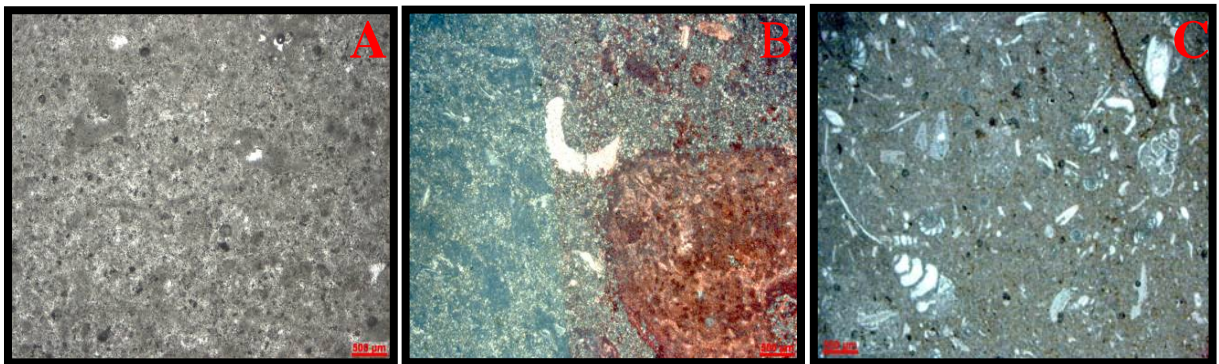
FIGURA 9 - Fotomicrografias mostrando os tipos de calcários presentes na seção estudada, segundo a classificação de DUNHAM (1962). (A) mudstone (PC-5,85), (B) wackestone (PC-3,0 / rocha tingida parcialmente por alizarina S) e (C) packstone (PC-14,2). Polarizador paralelo (P//).
