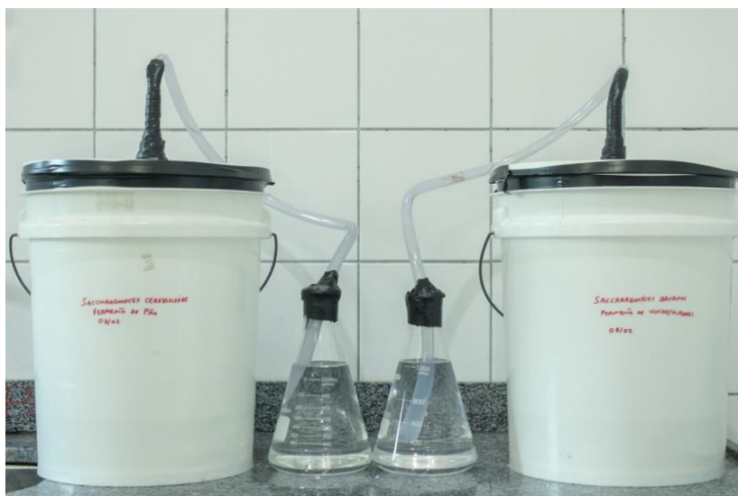
Figura 1. Fermentadores confeccionados com baldes e erlenmeyers para acondicionar o hidromel durante a etapa de fermentação. Fonte: Autor da pesquisa.
