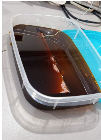
(d) Processo de corrosão química do cobre excedente.
