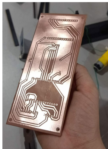
(e) PCB após o processo de corrosão.
