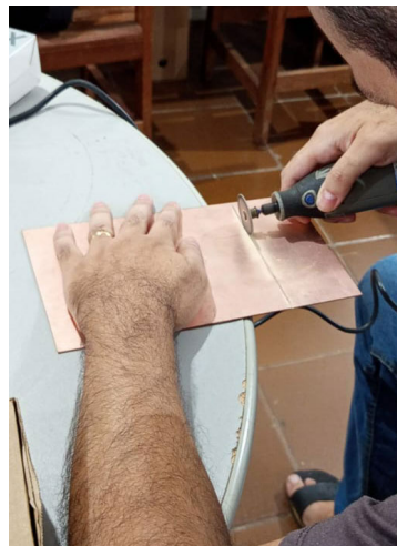
(c) Processo de corte da placa folheada em cobre.
