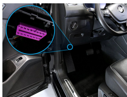
(b) Porta OBD-II e sua localização típica em veículos.
