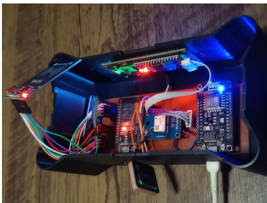
(c) PCB encaixada na caixa já impressa.
