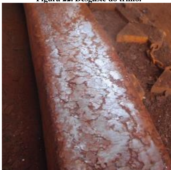
Figura 22. Desgaste do trilho.
