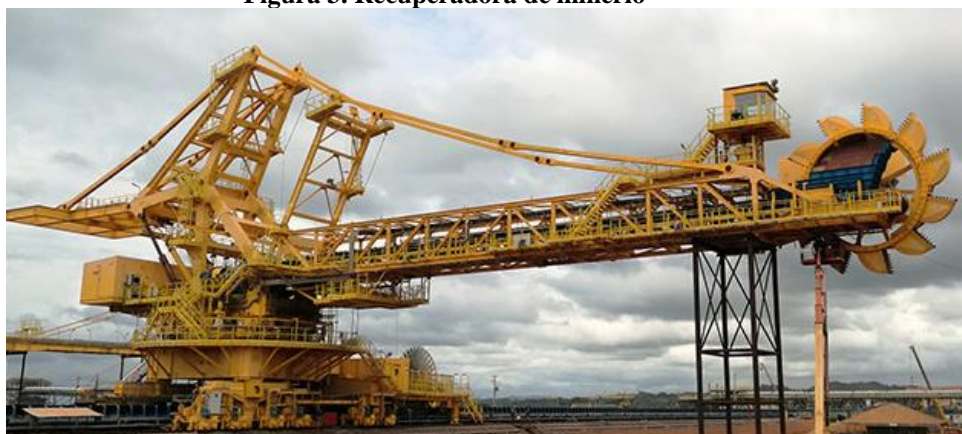
Figura 3. Recuperadora de minério
