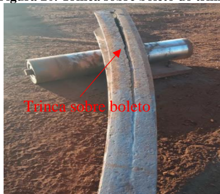
Figura 20. Trinca sobre boleto do trilho.
