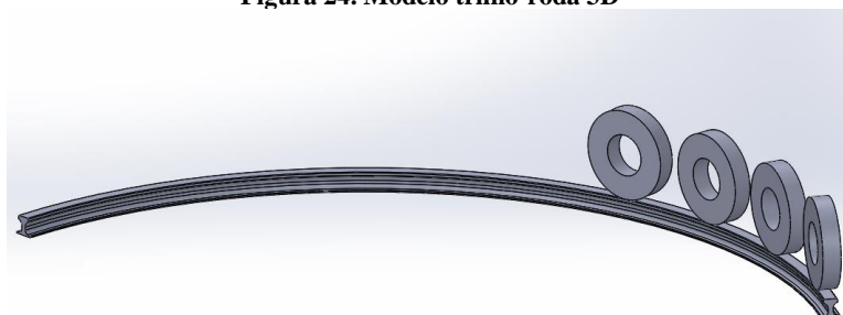
Figura 24. Modelo trilho-roda 3D
