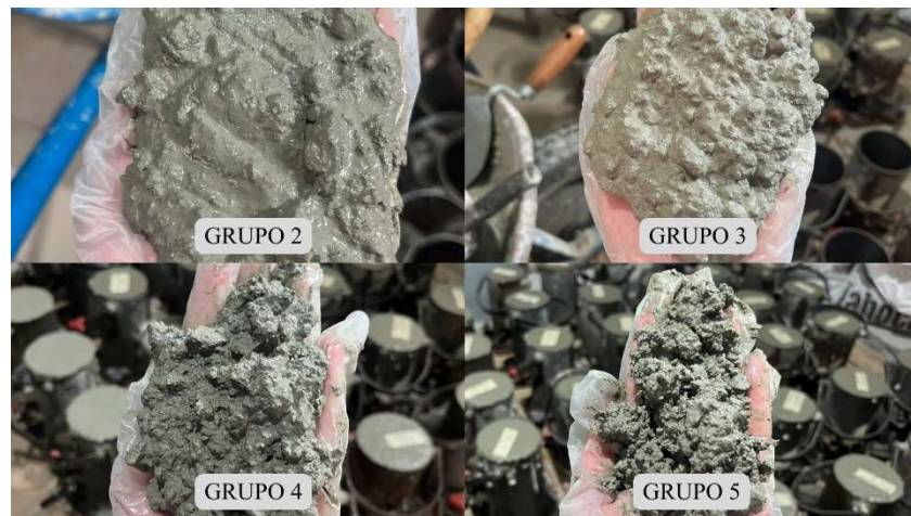
Figura 6 - Aspectos visuais apresentados pelos concretos com diferentes teores de agregado reciclado no estado fresco.
