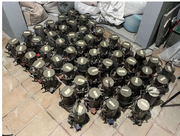
Figura 4 - Corpos de prova moldados
