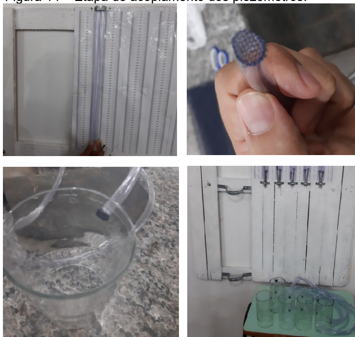
Figura 14 – Etapa de acoplamento dos piezômetros.
