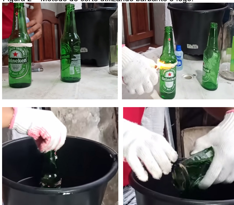
Figura 2 – Método de corte utilizando barbante e fogo.
