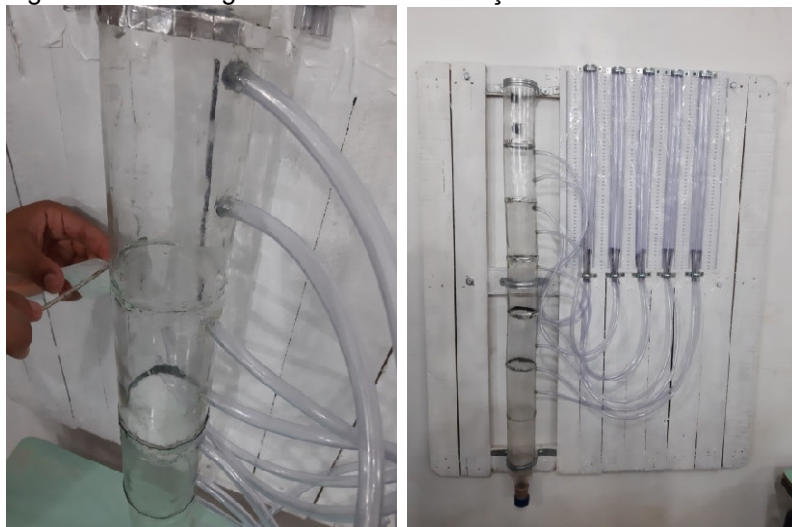
Figura 15 – Montagem da coluna de filtração.
