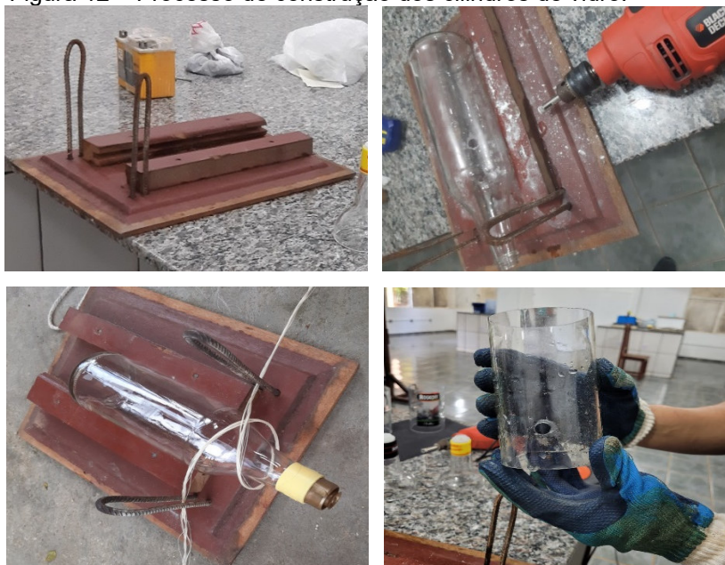
Figura 12 – Processo de construção dos cilindros de vidro.
