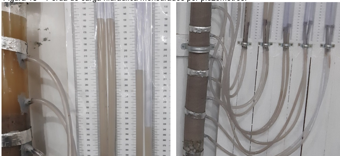
Figura 18 – Perda de carga hidráulica mensurados por piezômetros.
