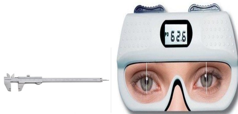
Figura 2 - a) Paquímetro; b) Pupilômetro
