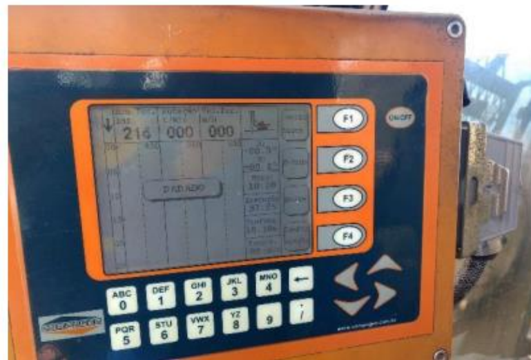
Figura 9 - Controle da pressão e velocidade do bombeamento de concreto.
