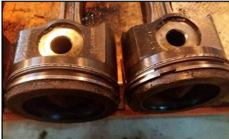
Figura 19. Desgaste nos anéis de vedação e de lubrificação do pistão.
