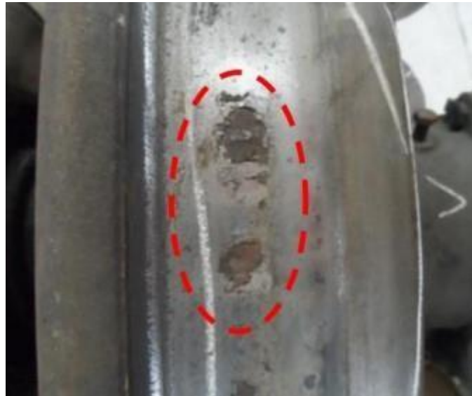
Figura 10. Roda ferroviária desgastadas por rolamento.
