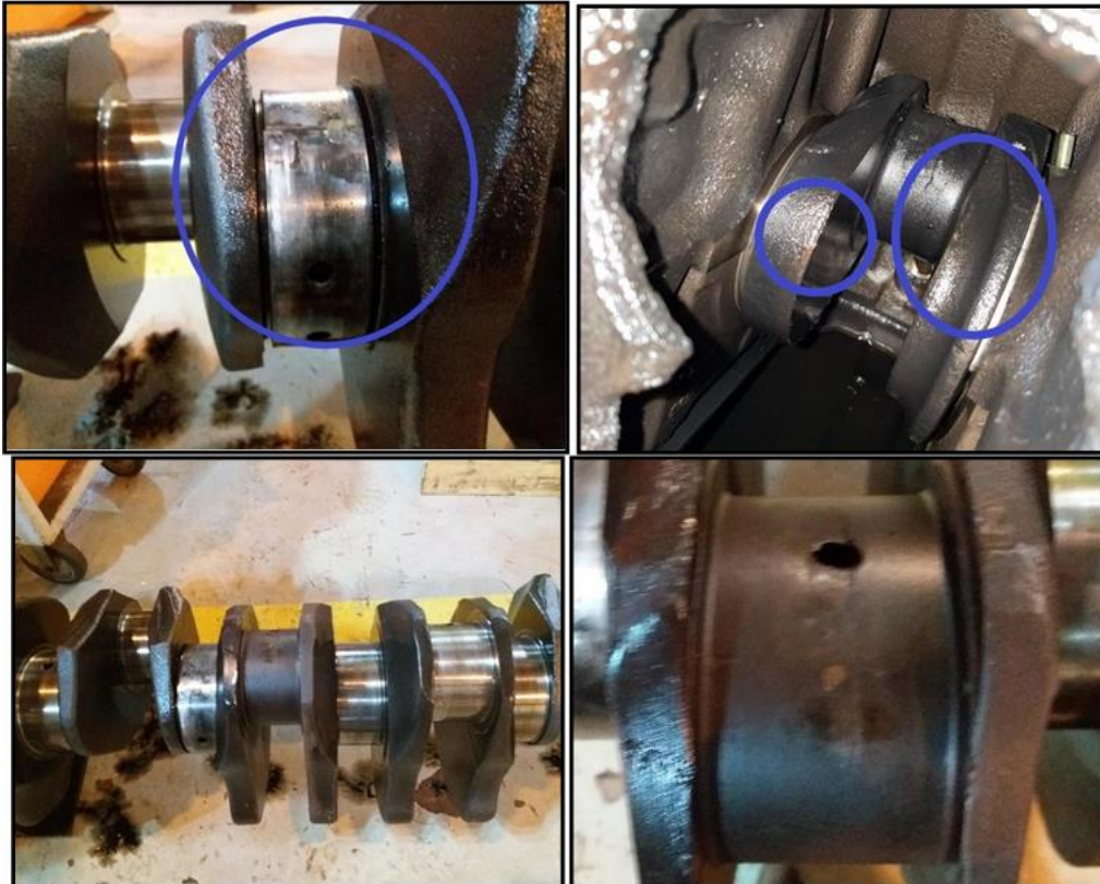
Figura 20. Casquilho deslocado e fundido com o munhão.
