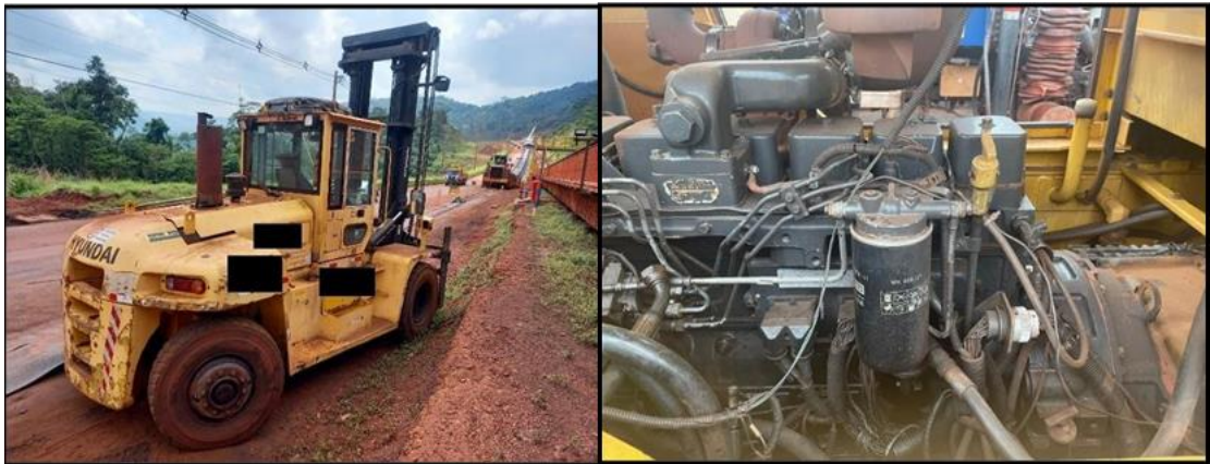
Figura 17. a) Registro da empilhadeira após a ocorrência e b) Motor diesel falhado.
