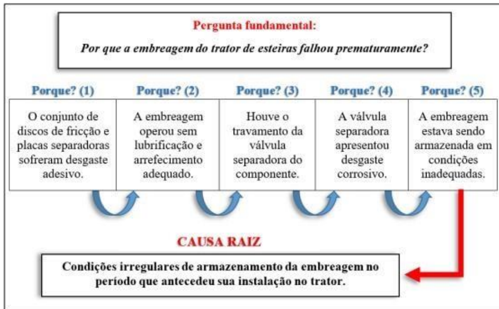
Figura 15. Método dos cinco porquês aplicado a falha de uma embreagem de um trator de esteiras.
