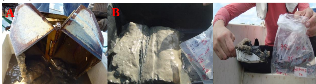
Figura 5- Técnicas de amostragem de sedimento. a) Dragas de Van Veen; b) Amostra colocada na basqueta e c) Acondicionamento da amostra.
