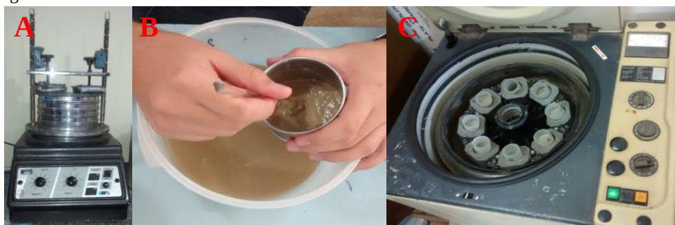
Figura 8- Métodos de análise de granulometria a) Agitador Ro-tap; b) Peneiramento à úmido; c) Centrífuga.
